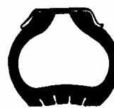
Falta de pressão
