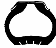
Falta de pressão
