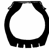
Excesso de pressão
